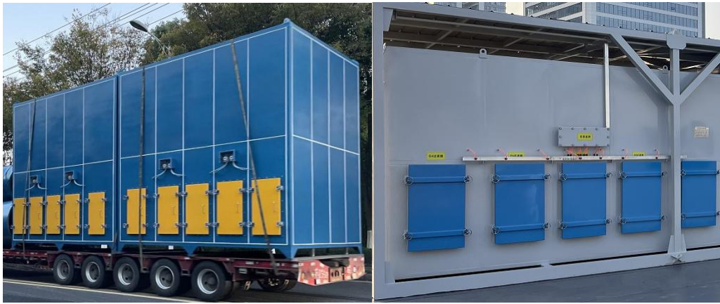
图 6.3-4 干式过滤器实物图
