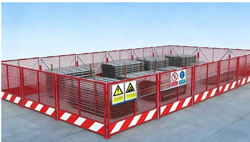
图4.1.8-3 盘扣架材料堆放防护示意图
