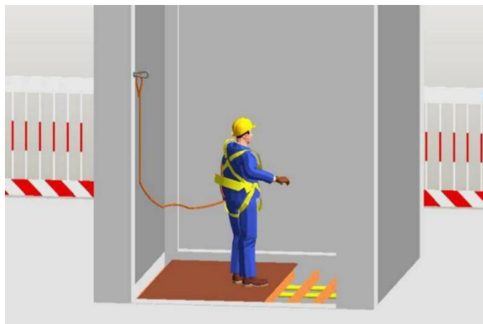
图 5.9.3-3 电梯井作业安全带系挂点示意图
