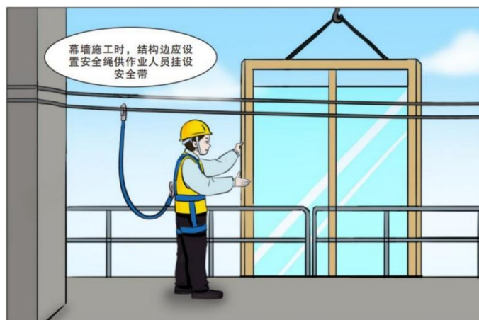
图 5.9.1-3 设置安全带挂设安全绳示意图
