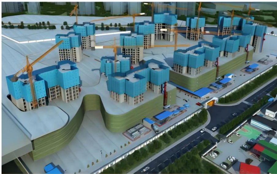
图4.1.1-1 施工场地布置示意图
