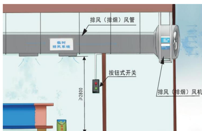
图 5.9.2-2 加工车间通风排烟示意图
