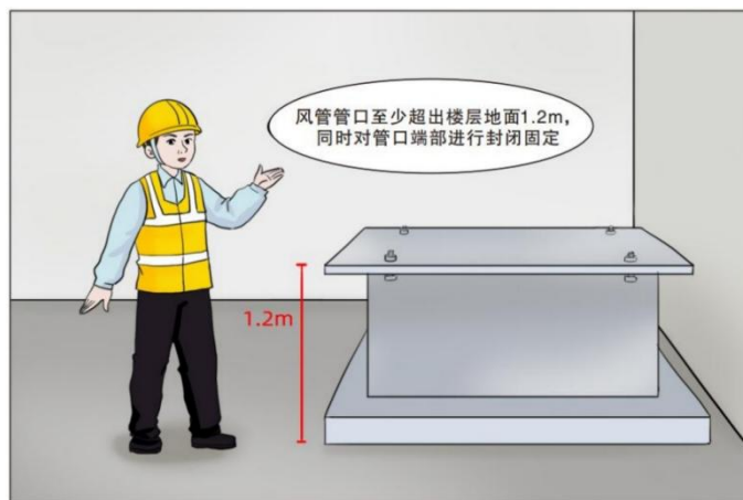
图 5.9.2-4 风管临边防护示意图
