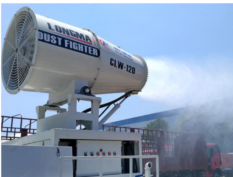
图 8.1.4-2 雾炮机在土方作业区降尘图
