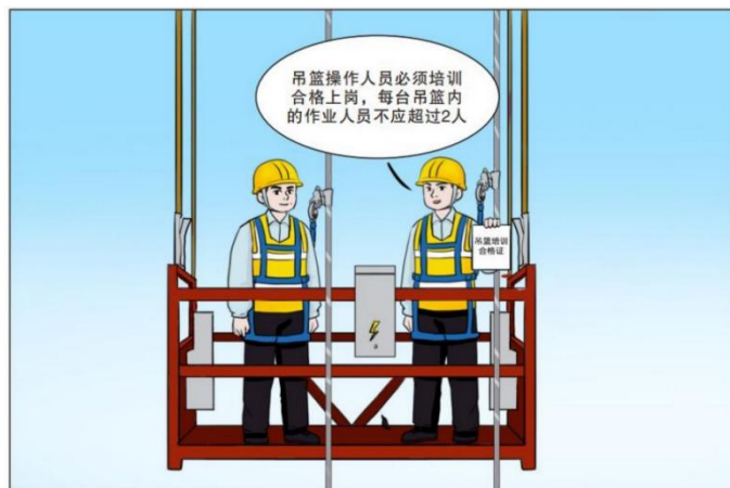
图 5.9.1-5 施工吊篮作业人员示意图
