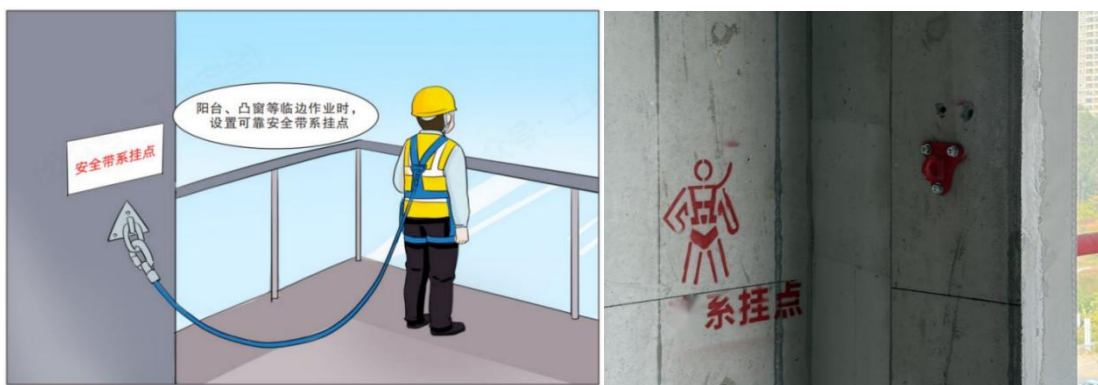
图 5.9.6-1 铝窗、阳台护栏安装安全带系挂点示意图
