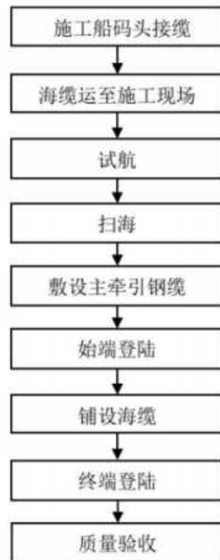
图 3.5.1-7 海缆敷设施工工艺
