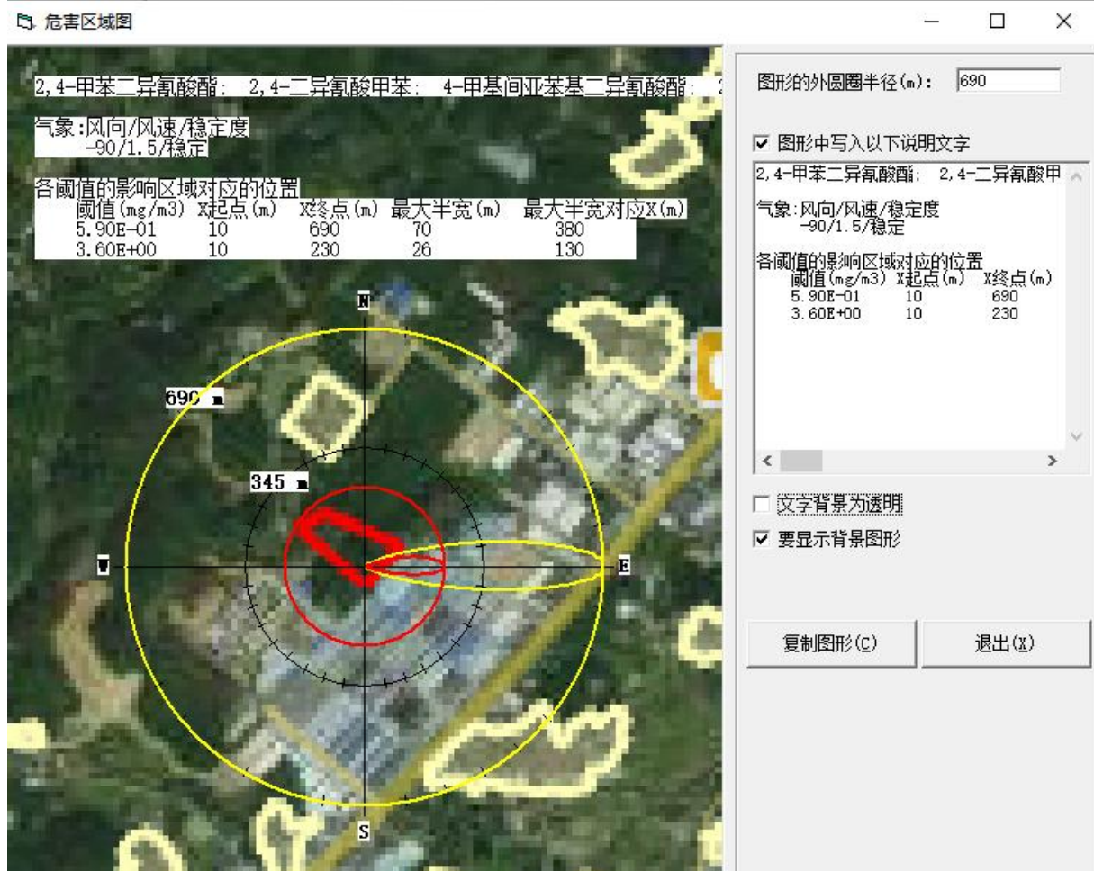
图 5.7-11 火灾未完全燃烧释放的甲苯二异氰酸酯超过给定阈值最大影响区域图
