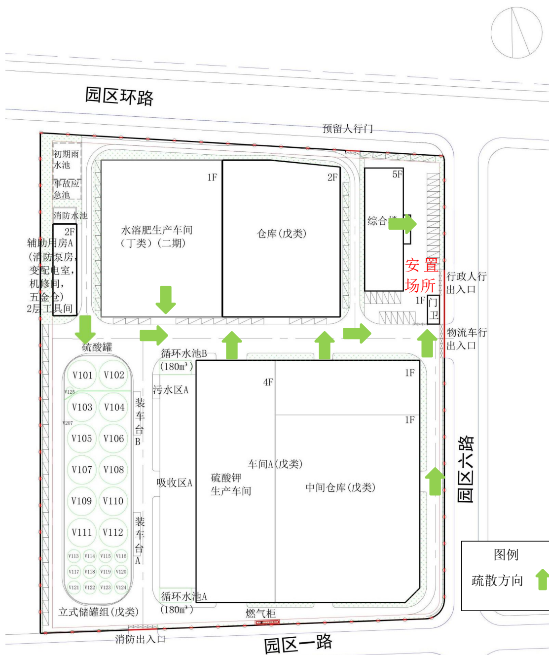
图 5.2.8-9 项目应急疏散通道、安置场所图
