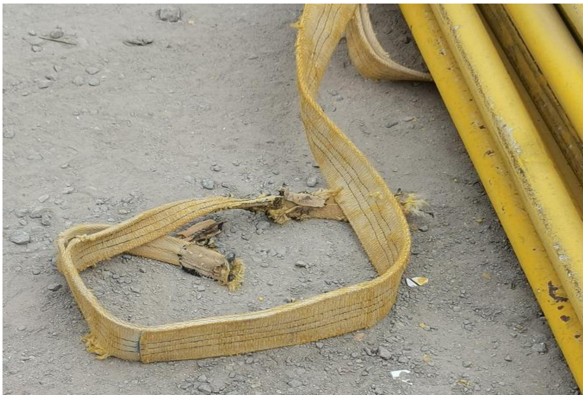
图 4：断裂的扁平吊装带
