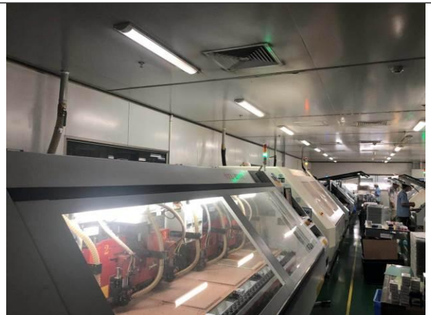
钻孔机自带的含尘废气收集装置
