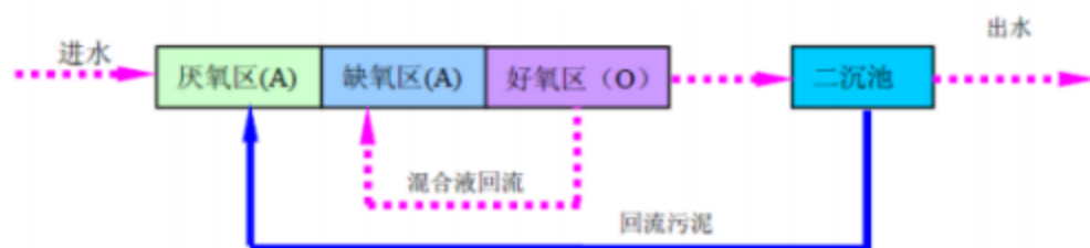
图 7.3-2 改良 A 2 /O 法一体化设备工艺流程图
