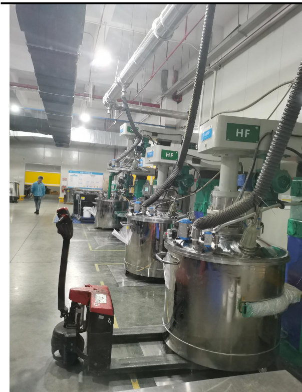
主厂房—单轴调粘机（含放空管道）
