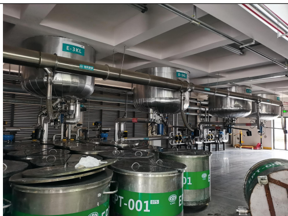
树脂生产线-反应釜底部卸料口
