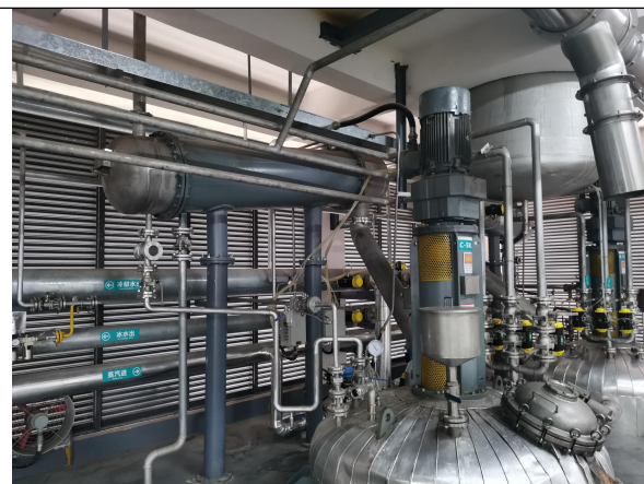
树脂生产线-反应釜配套冷凝管
